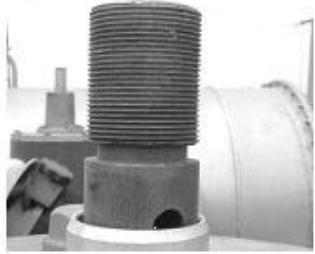
图一 引线接头放电痕迹
