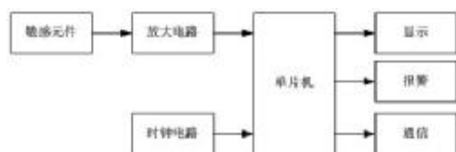
图1 甲烷浓度控制系统硬件结构图
