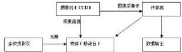
图1 显微三维测量系统工作过程示意图
