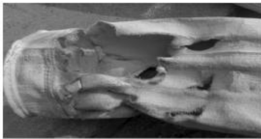
图1 磨损滤袋的实际情况
