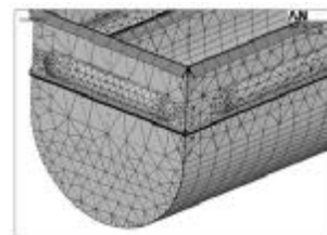
图4 4mm 壁厚车箱加焊角钢后网格划分模型
