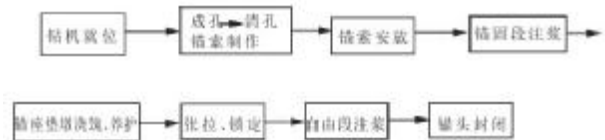
图1 锚索施工工艺流程
