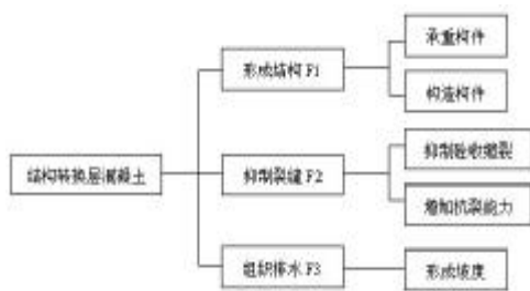
图1 结构转换层功能流程图
