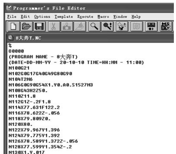
图 7:执行后处理生成 NC 数控程序
